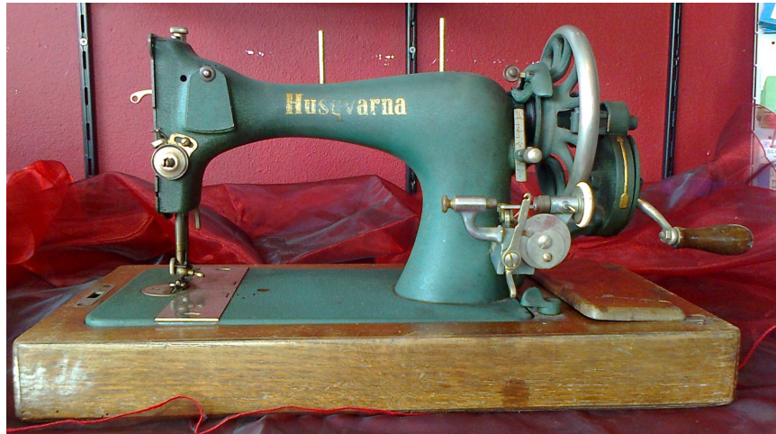
(Husqvarna handnaaimachine met de mogelijkheid achterwaarts te stikken, jaren '40. coll. R. Arends)
