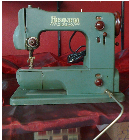
(De eerste Husqvarna zigzagmachine met kniehendel, 1947 ('Vapenfabrik'). coll. R. Arends)
