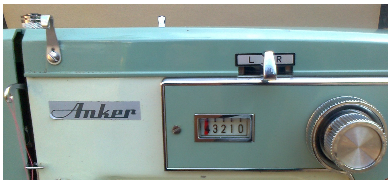
(Instelinrichting van voetdruk, positie van de naald, steekbreedte en steeklengte bij een Anker.)
