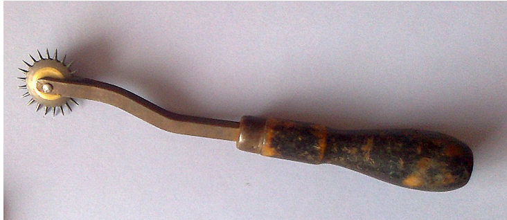
(Messing Radeerwielje met gesmeed ijzer in houten handvat. coll. R. Arends)
